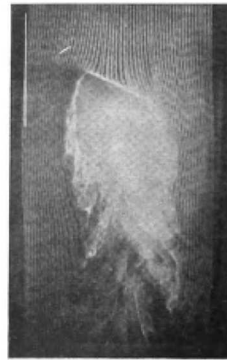
Fig. 3. - Indication de la vitesse de l'air par des vibrations imprimées aux filets de fumée.
